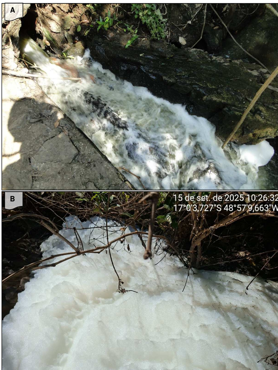
Figura 3 - Ponto de lançamento do efluente tratado. A) dispositivo de descarga na qual é possível observar a formação de espuma; B) espuma espessa e persistente no corpo recepto. Fonte: UTPA, vistoria técnica em 15/09/2025.
